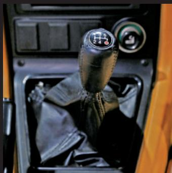
RX-7專用5速手排變速箱，倒車檔位在右下方。為了RX-7的專用需求，特別開發了控制機箱，讓排檔桿設計較短，方便握持。
