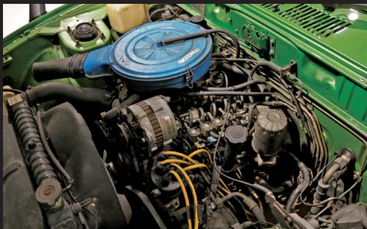
引擎室。由於引擎較小巧，因此實現了將引擎配置在前車軸後方的前中置佈局。
